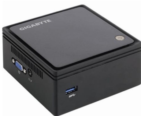
圖 3. 以 Intel® IoT Gateway 平台參考架構為基礎的硬體，例如搭載 Intel Atom® 處理器的 GIGABYTE GB-BXBT-3825，可在 MIMIC IoT 模擬器產生的模擬環境中，定位為受測裝置 (DUT)。 (資料來源：GIGABYTE)
