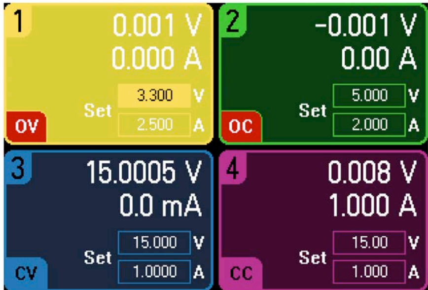
圖 8：顯示超電壓保護、過載電流保護、恆定的電壓和恆定的當前方式的電源面板
